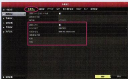
步驟3-2: 浮動IP設定，點選外網設定並啟動DDNS，輸入浮動IP的位址、帳號及密碼
